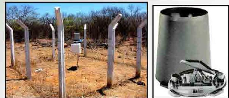
**Pluviógrafo digital de cubas basculantes**
